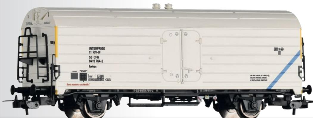
Kühlwagen Icheqs „Interfrigo“ der CFR
